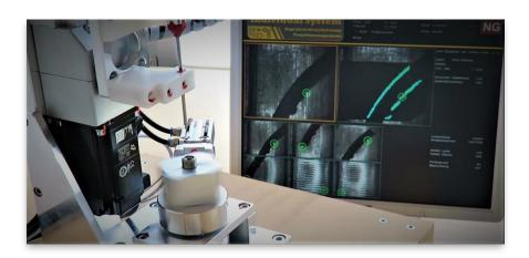
Mögliche Anwendungen sind Prüfstationen zur stichprobenartigen Innenkonturprüfung, sowie Inline-Prüfungen zur 100% Kontrolle.
